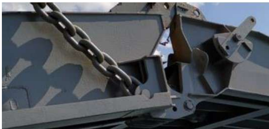
Εικόνα 10: Διάταξη συγκράτησης αλυσίδας στον καταπέλτη (clevis brackets)
